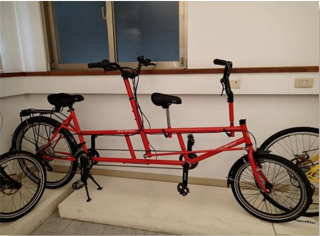
➤ 親子協力車，控制轉彎的龍頭在後座，小孩坐前面，防止孩子睡著了爸媽卻沒發現
